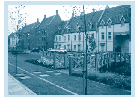
Deze wadi of begroeide greppel beschermt het Engelse Upton tegen overstromingen. © Tpa
